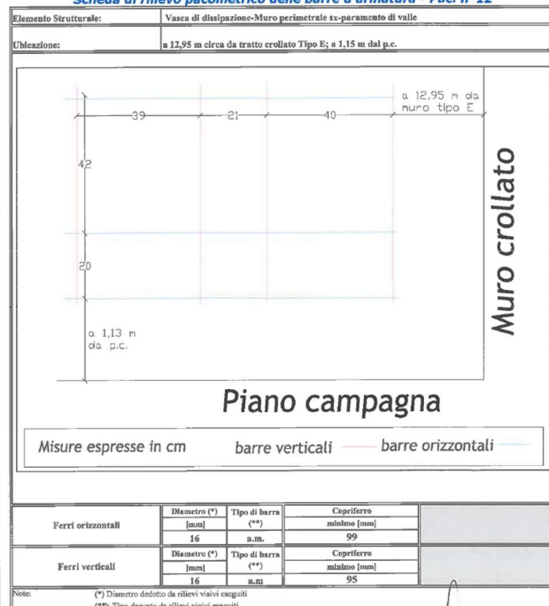
Scheda di rilievo pacometrico delle barre d'armatura - Pac. n°12
