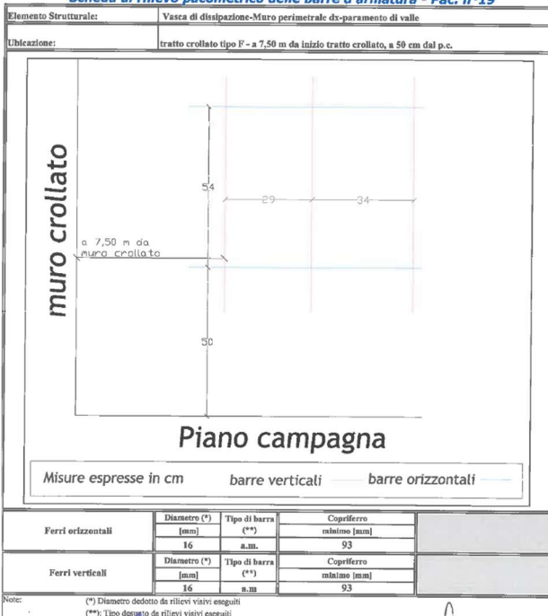
Scheda di rilievo pacometrico delle barre d'armatura - Pac. n°19
