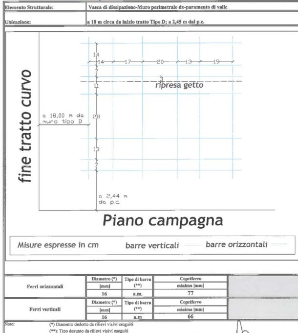
Scheda di rilievo pacometrico delle barre d'armatura - Pac. n°19
